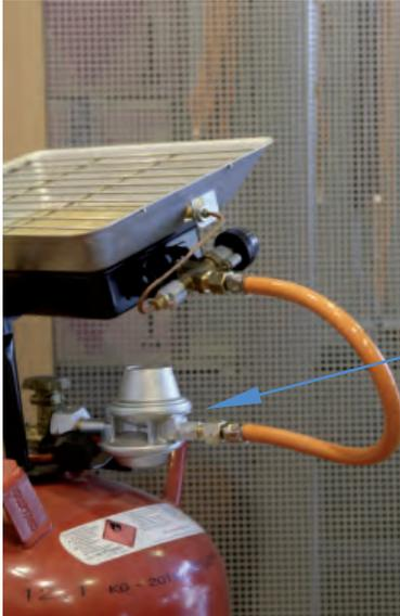
Druckregelgerät mit integrierter Überdrucksicherheitseinrichtung
