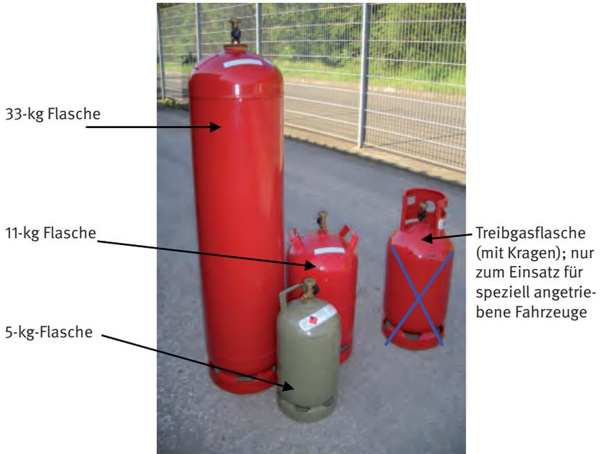
Abb. 2: Flüssiggasflaschen (Brenngasflaschen) ohne Ventilschutzkappe
