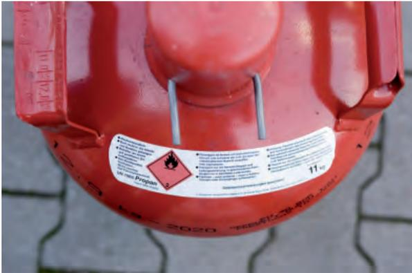
Abb. 52: Kennzeichnung Flüssiggasflasche (Gefahrgutaufkleber)
