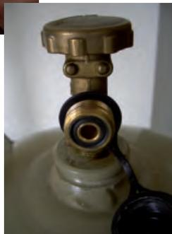
Nach der Herstellung der Anschlussverbindung (Absperrventil/Druckregelgerät bzw. Absperrventil/Hochdruckschlauch) muss diese vorsichtig bei geöffnetem Flüssiggasflaschen-Absperrventil und geschlossener Geräteabsperrearmatur auf Dichtheit geprüft werden. Die Dichtheitsprüfung ist unter Betriebsdruck mit einem schaumbildenden Mittel (z.B. Lecksuchspray) durchzuführen, Abb. 17. Betriebsdruck besteht bei geöffnetem Absperrventil der Flüssiggasflasche und geschlossener Absperrarmatur des Gasgerätes.
